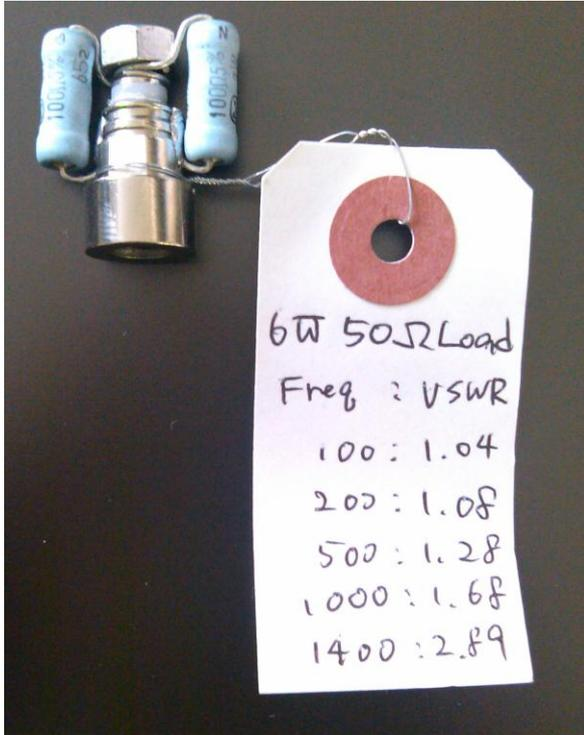
SMA コネクタに酸化金属皮膜抵抗
